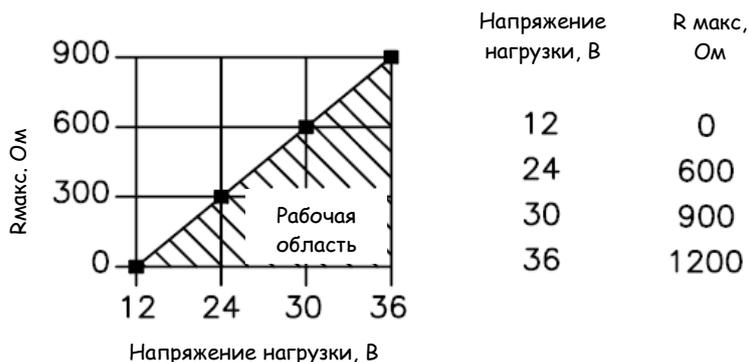
При определении возможного удаления вторичных приборов от электронного блока массового расходомера необходимо принимать в расчет их внутреннее сопротивление.
